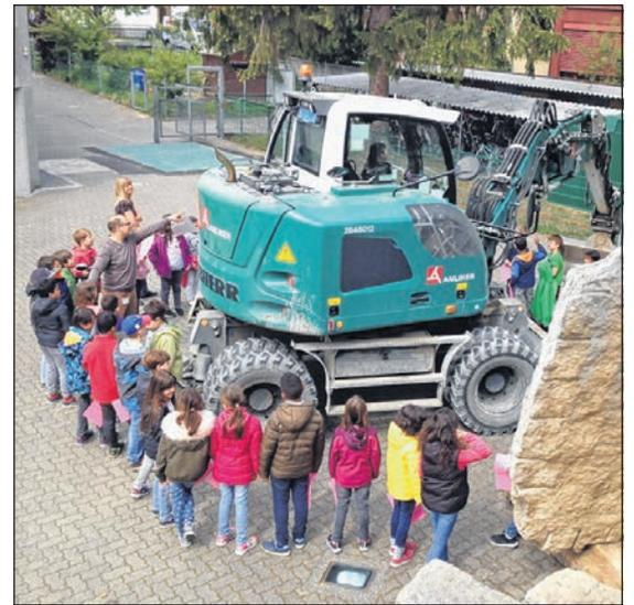
erfahren, wie eingeschränkt das Sicht- und Beobachtungsfeld des Baggerführers bei einem Einsatz ist. Dieser hat nicht wie bei einem Auto eine Rundumsicht, nach hinten hat er praktisch keine Sicht und muss sich darauf verlassen können, dass sich dort niemand befindet.
