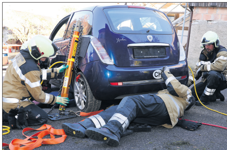
Um die eingeklemmte Person zu befreien, wird das Fahrzeug zuerst abgestützt, dann wird hinten ein Pressluftkissen platziert zum Anheben.
