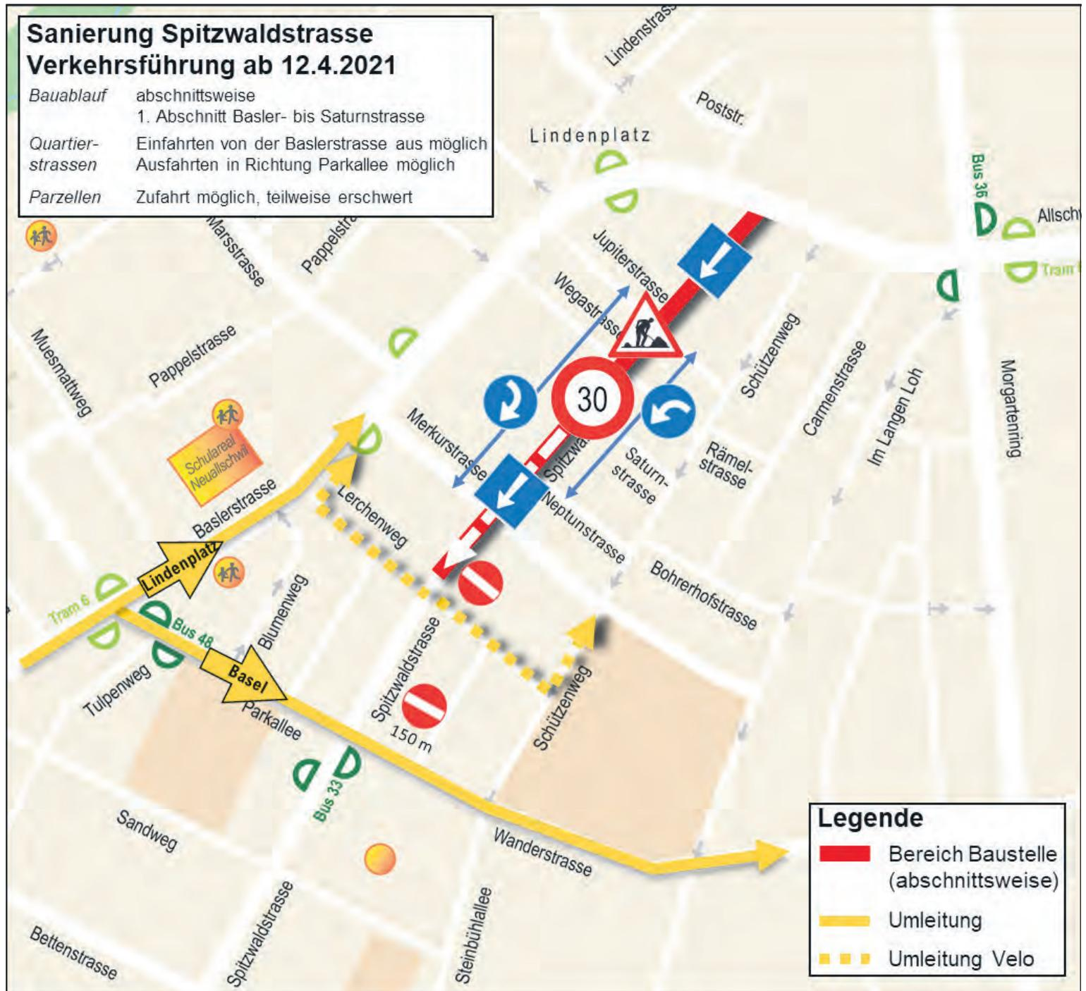
Die Spitzwaldstrasse befindet sich im Abschnitt Baslerstrasse bis Lerchenweg in einem unzureichenden Zustand und muss saniert werden. Die Sanierungsmassnahmen beinhalten einen Ersatz des Ober- und Unterbaus (Strasse und Trottoir). Im Zuge dieser Bauarbeiten wird die öffentliche Beleuchtung neu verkabelt und verrohrt. Der Ge-
