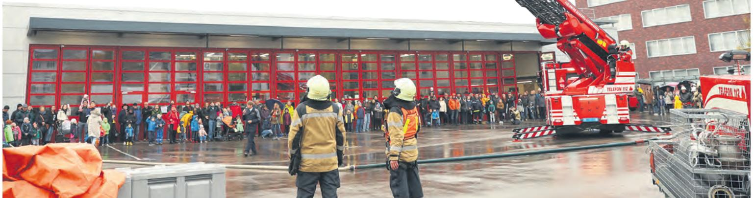
Gleich zu Beginn gibts die Vorführung der neuen Drehleiter, die auf eine Rettungshöhe von 32 Meter ausgefahren werden kann.
