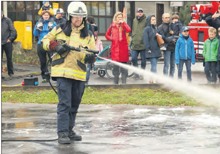
Michael Kneier demonstriert die neue Hochdrucklöschanlage. Mit ihr kann bei einem Druck von 200 Bar Wasser gespritzt werden.
