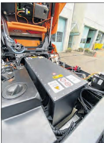
Der leistungsstarke Akku hält mit einer Ladung ungefähr 6 Stunden und kann binnen 2 Stunden wieder aufgeladen werden.
