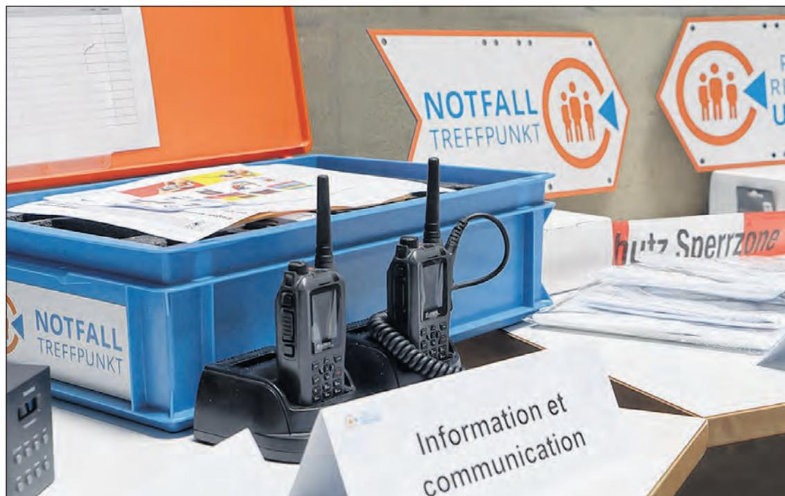
Die Grundausrüstung eines Notfalltreffpunkts erlaubt auch dann eine Kommunikation unter den Einsatzkräften, wenn andere Kommunikationsmittel ausgefallen sind.
