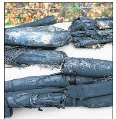
Ein Muffentyp führte im Sommer zu durchgebrannten Stromleitungen und drei Stromausfällen. Foto zVg
